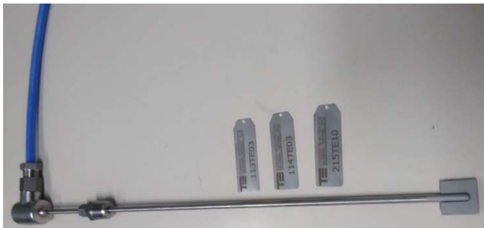
Рисунок 4 - Общий вид ТП исполнения 113TE03, 114TE03, 215TE10
