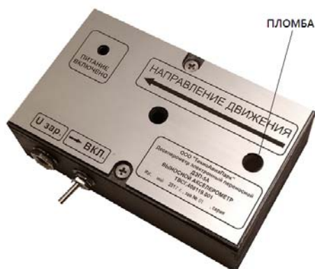
Рисунок 2 - Схема пломбировки выносного акселерометра от несанкционированного доступа
