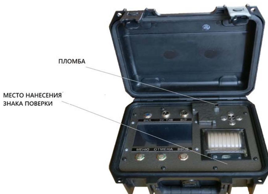
Рисунок 2 - Схема пломбировки выносного акселерометра от несанкционированного доступа
