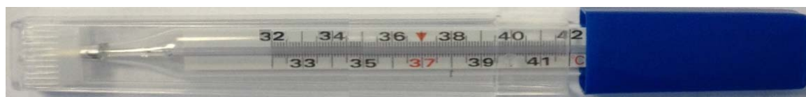
Рисунок 2 - Термометр медицинский максимальный стеклянный «MERIDIAN», безртутный
