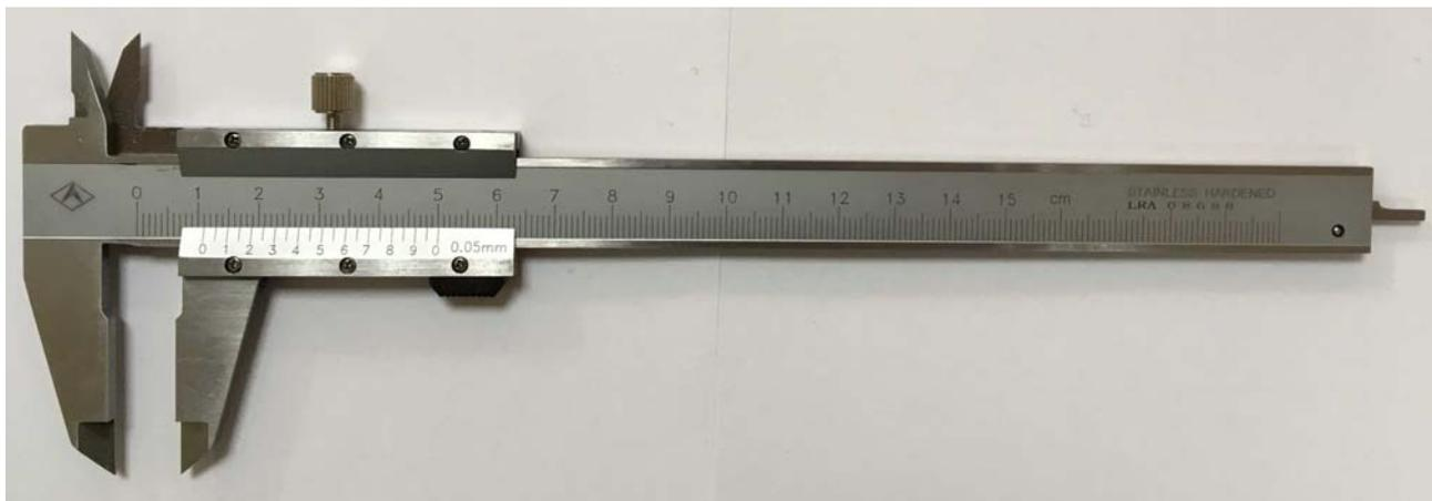
Рисунок 1 - Общий вид штангенциркулей серии 601 модификации двусторонние с глубиномером
