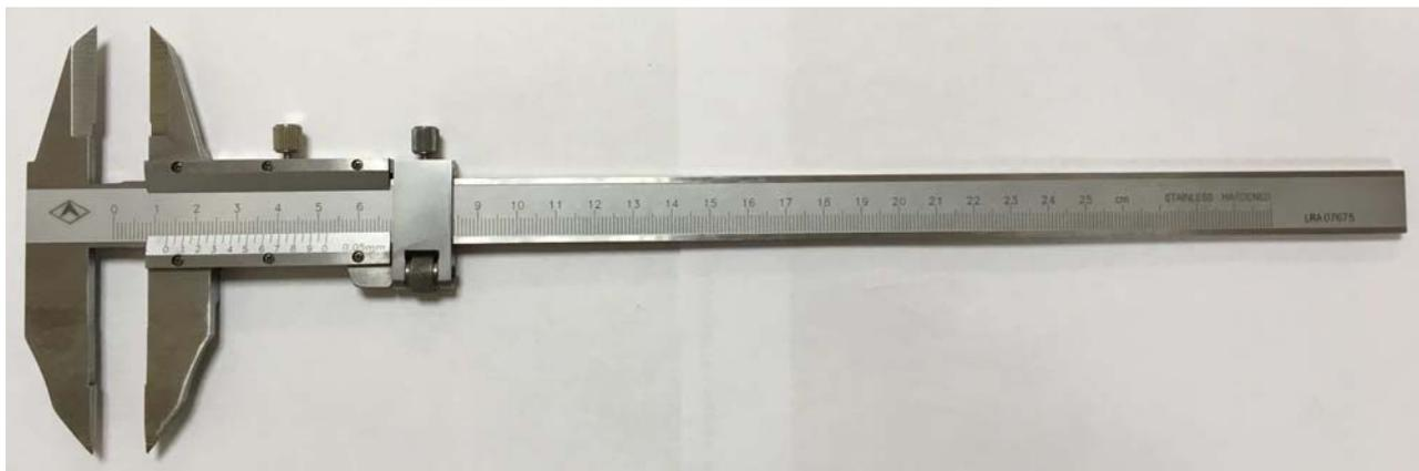
Рисунок 4 - Общий вид штангенциркулей серии 602Т модификации двусторонние без глубиномера
