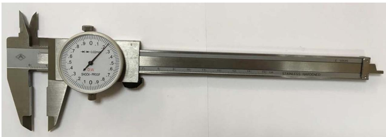
Рисунок 7 - Общий вид штангенциркулей серии 604 модификации двусторонние с глубиномером
