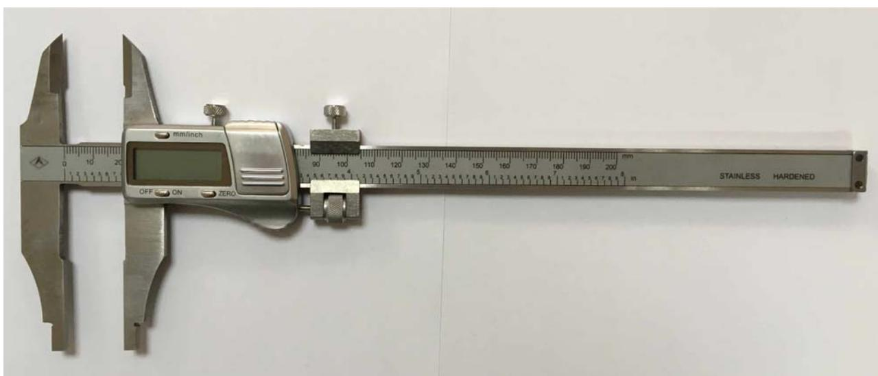
б) цифровое отсчетное устройство в металлическом корпусе
