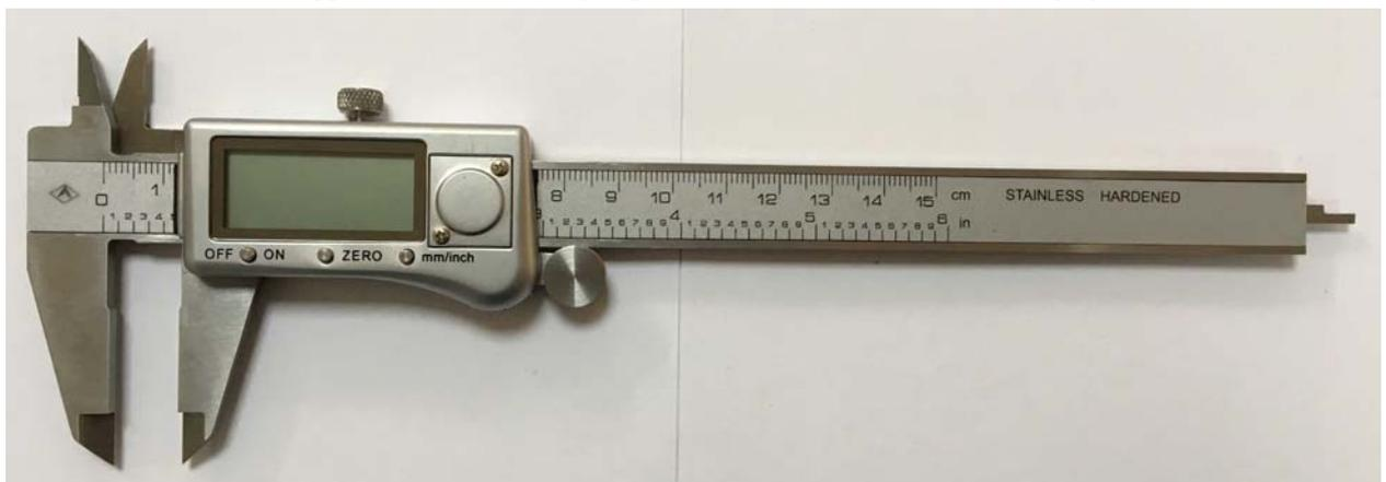
б) цифровое отсчетное устройство в металлическом корпусе
