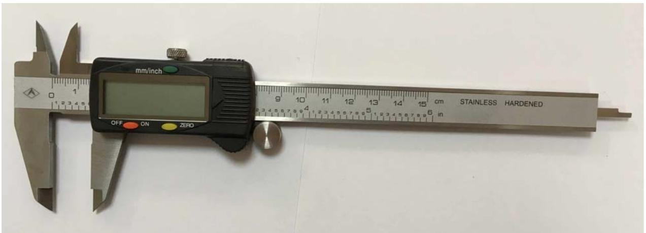
а) цифровое отсчетное устройство в пластмассовом корпусе
