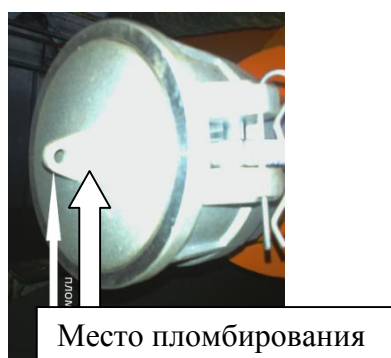
Рисунок 5 - Заглушка открывания трубопровода слива топлива из АЦН
