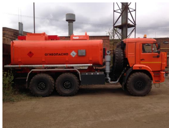
Рисунок 2 - Общий вид АЦН с двумя секциями
