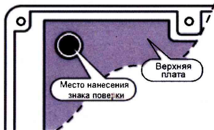
Рис. Б.5 Место нанесения знака поверки - на крепежный винт защитного каркаса электронного модуля (р.12.4 РЭ)
