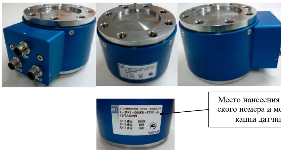
Место нанесения заводского номера и модификации датчика
