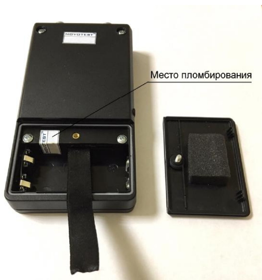
Рисунок 3 - Место пломбирования измерителей NOVOTEST Арматуроскоп
