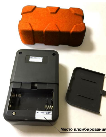
Рисунок 4 - Место пломбирования измерителей NOVOTEST Арматуроскоп-М
