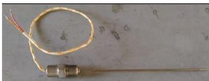
Рисунок 6 - Общий вид ТП исполнений 113TE04, 114TE04, 215TE05
