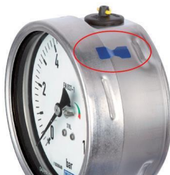
Рисунок 5 - Пример пломбирования манометров нанесением на кольцо и боковую поверхность корпуса специальной наклейки
