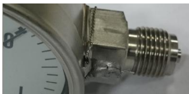
Рисунок 4 - Пример пломбирования манометров продеванием контрольной проволоки и навешивания свинцовой или пластиковой пломбы.
