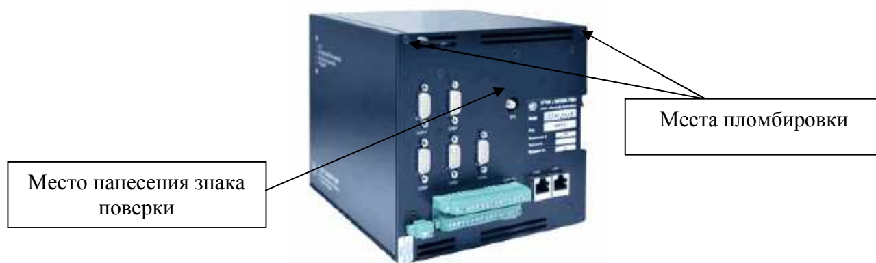
Рисунок 1 - Общий вид устройств с указанием мест пломбирования от несанкционированного доступа и нанесения знака поверки
