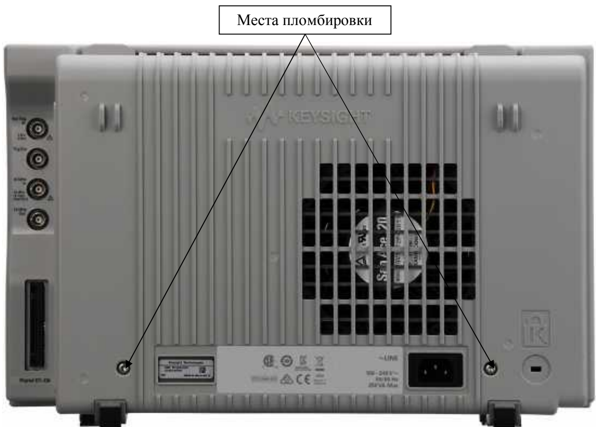
Рисунок 3 - Общий вид базового блока анализаторов CX3322A, CX3324A. Вид сзади. Схема пломбировки от несанкционированного доступа
