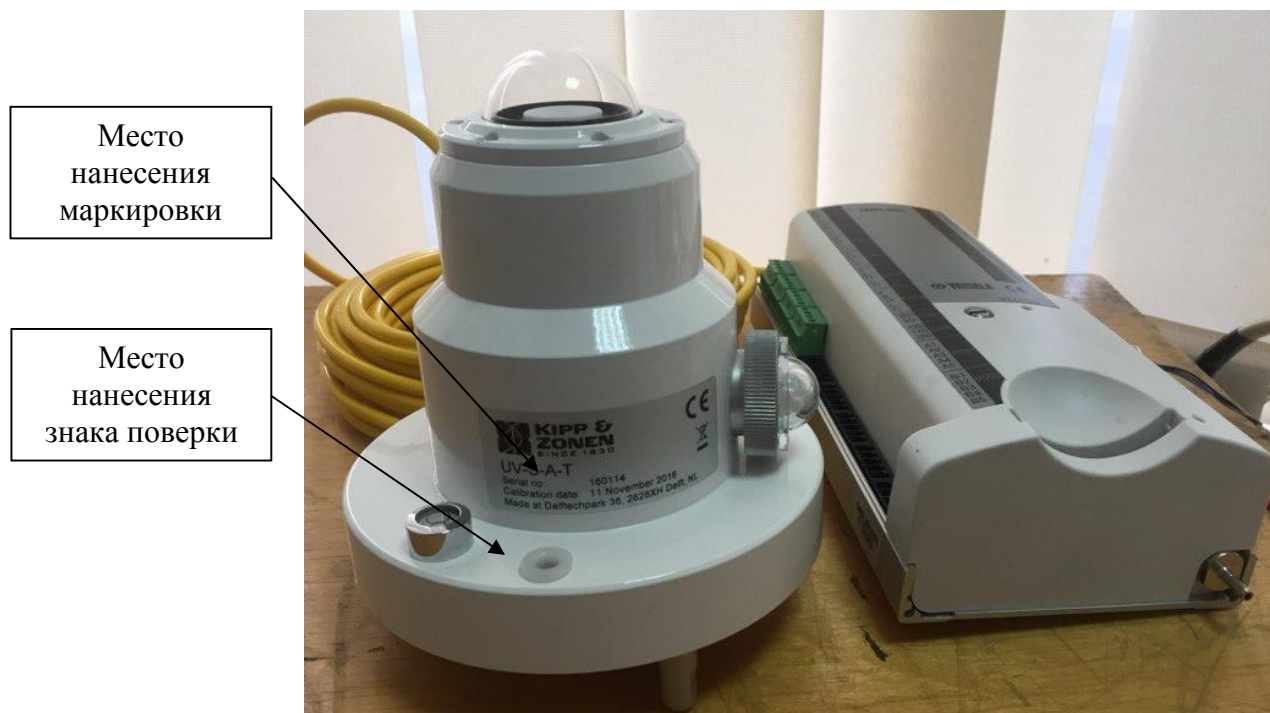
Рисунок 1 - Общий вид радиометров ультрафиолетовых UVS (UVS-A-T и UVS-B-T) с обозначением места нанесения знака поверки и маркировки
