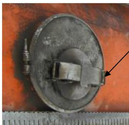
Рисунок 2 - Место пломбировки от несанкционированного доступа
