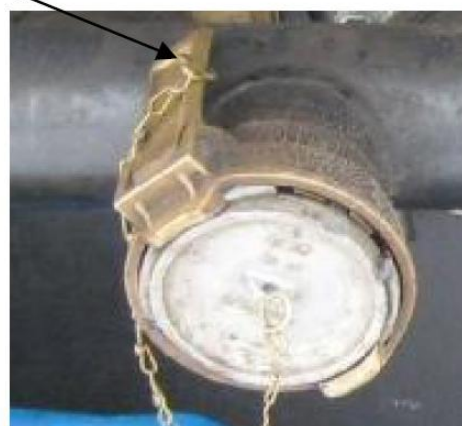
Рисунок 2 - Место пломбировки от несанкционированного доступа
