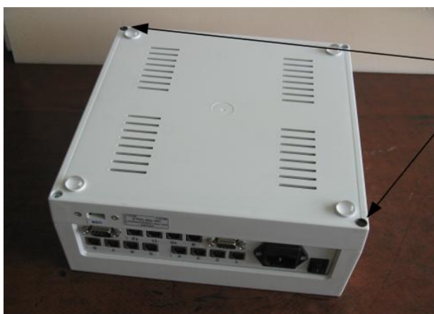
Рисунок 2 - Схема пломбировки от несанкционированного доступа
