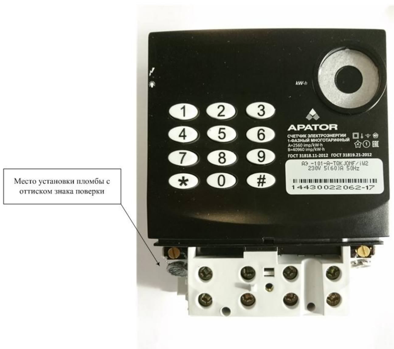
Рисунок 3 - Место установки пломбы с оттиском знака поверки
