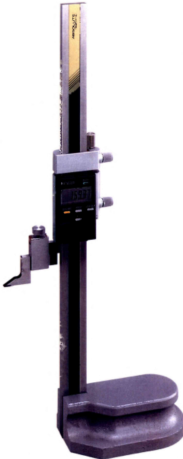
Рисунок 4 – Общий вид штангенрейсмасов серии 570
