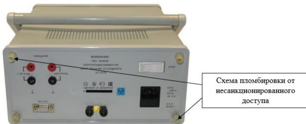
Рисунок 2 - Схема пломбировки от несанкционированного доступа
