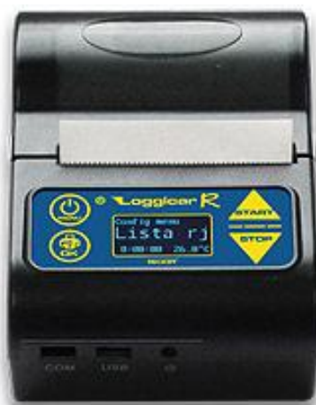
Рисунок 2 - Общий вид электронных блоков регистраторов температуры Loggicar-R
