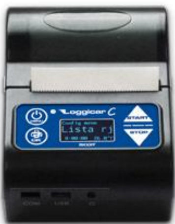
Рисунок 1 - Общий вид электронных блоков регистраторов температуры Loggicar-C
