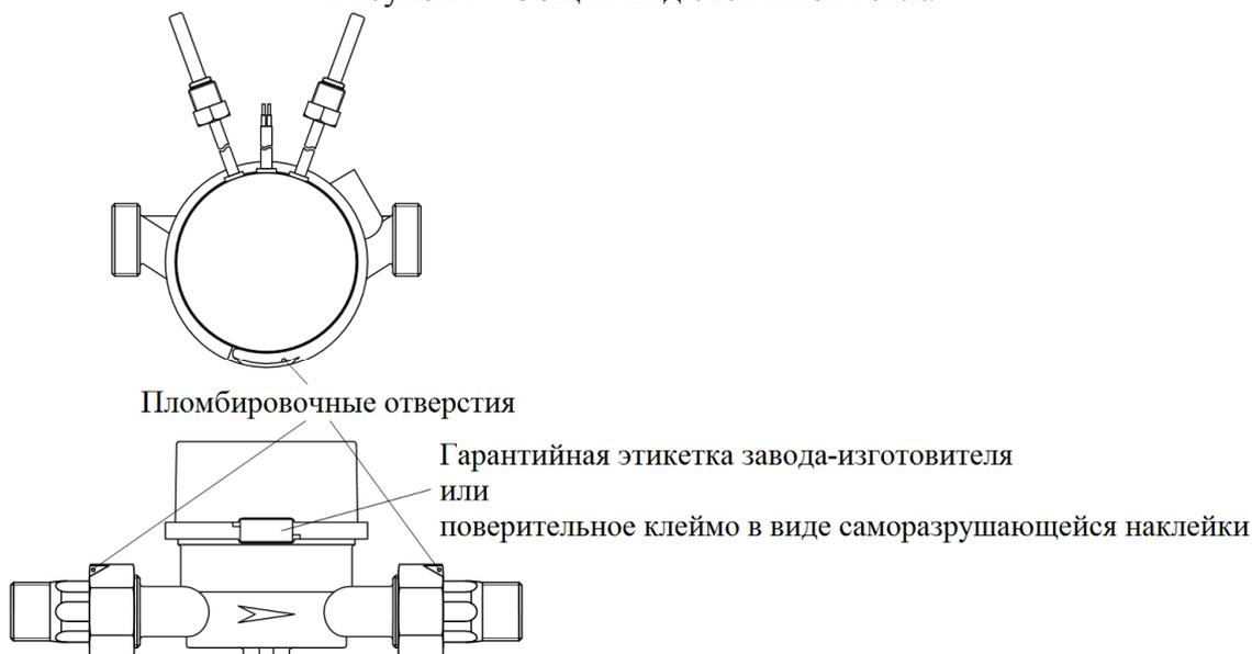
Рисунок 2 - Схема пломбировки от несанкционированного доступа, обозначения места нанесения знака поверки на счетчики тепла Гефест 06.V1.I, Гефест 06.V1.R, Гефест 06.V1.M, Гефест 06.V1.F, Гефест 15.V2.I, Гефест 15.V2.R, Гефест 15.V2.M, Гефест 15.V2.F
