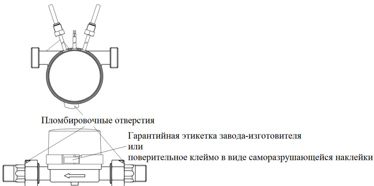
Рисунок 4 - Схема пломбировки от несанкционированного доступа, обозначения места нанесения знака поверки на счетчики тепла Гефест 15.А2.І, Гефест 15.А2.Р, Гефест 15.А2.М, Гефест 15.А2.F
