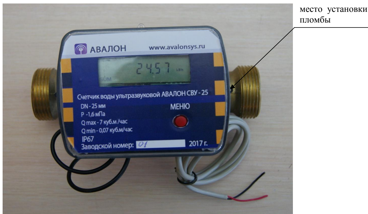
Рисунок 1 - Общий вид и схема пломбировки от несанкционированного доступа счетчиков ультразвуковых АВАЛОН
