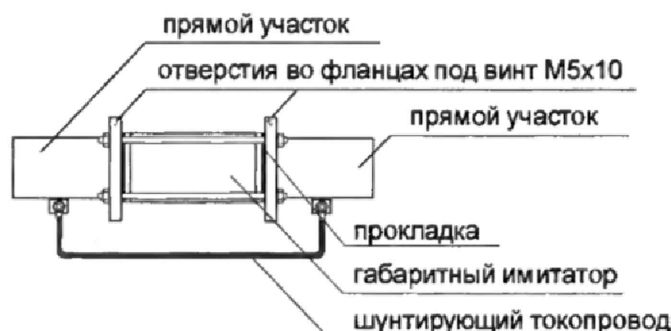
Рисунок 9.3 – Установленный габаритный имитатор
