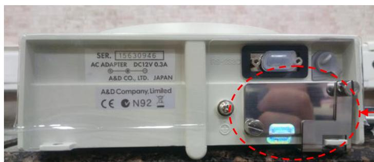
Место пломбировки с помощью разрушаемой наклейки и/или проволочной пломбы
