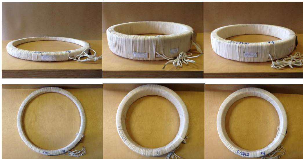
Рисунок 1 – Общий вид трансформатора тока ТВ-220*
