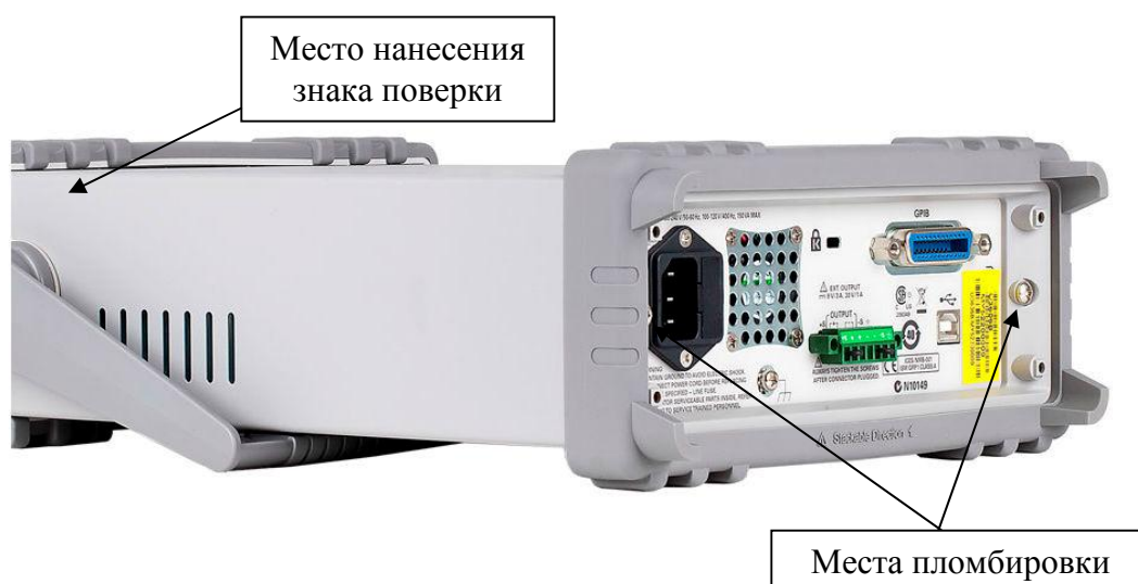
Рисунок 3 – Схема пломбировки от несанкционированного доступа, обозначение места нанесения знака поверки
