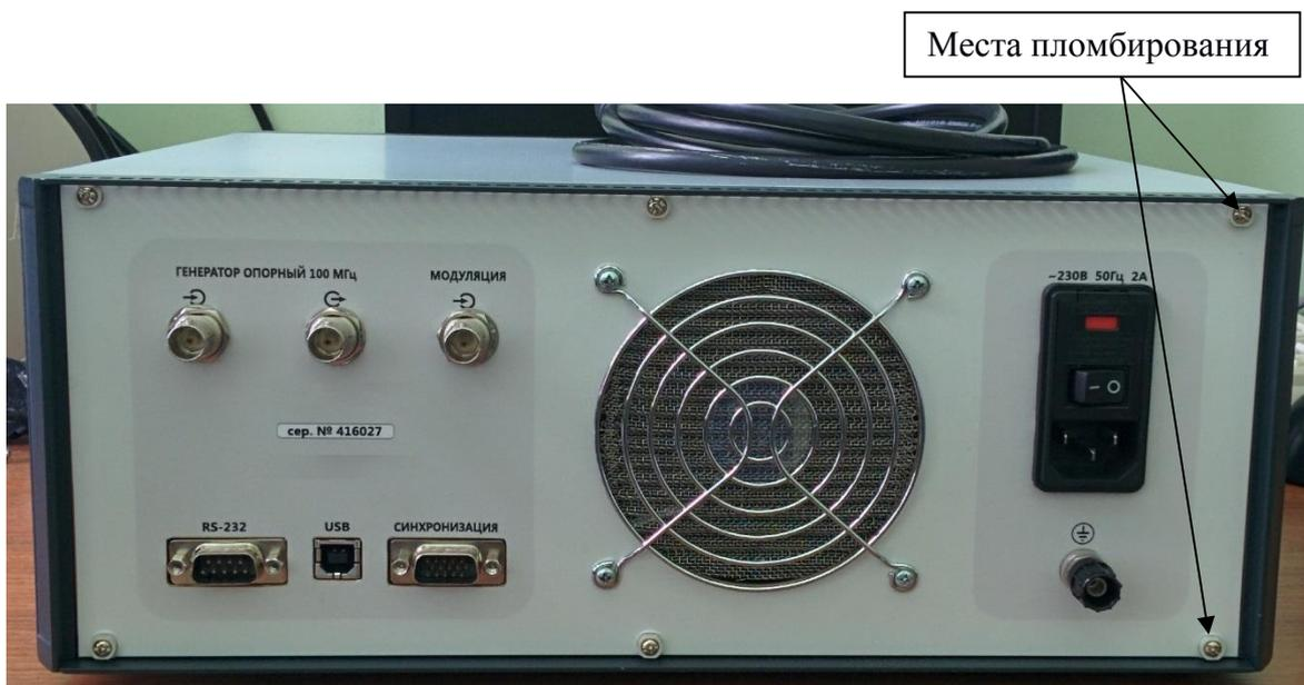
Рисунок 2 - Генератор Г4-МВМ-118. Задняя панель
