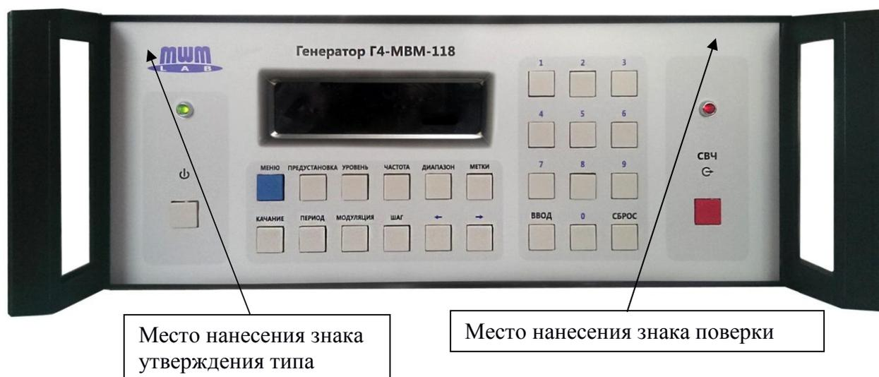
Рисунок 1 - Генератор Г4-МВМ-118. Передняя панель
