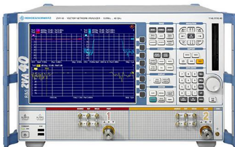
Рисунок 4 – Внешний вид ВАЦ Rohde&Schwarz ZVA40
