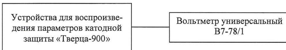
Рисунок 2 – Структурная схема для определения основной абсолютной погрешности воспроизведений напряжения постоянного тока (основного и защитного выхода)
