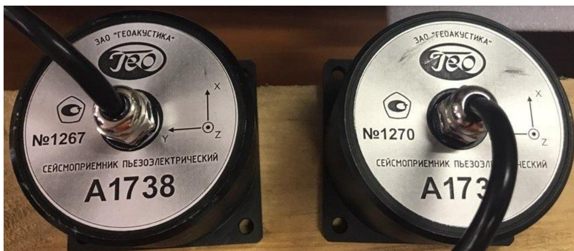
Рисунок 3 – Общий вид сейсмоприемников пьезоэлектрических А1738
