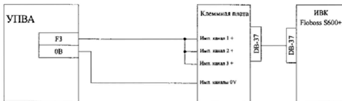
Рисунок Б.3. Схема подключения средств проверки при определении погрешности преобразования входных сигналов в значения объема и массы нефти
