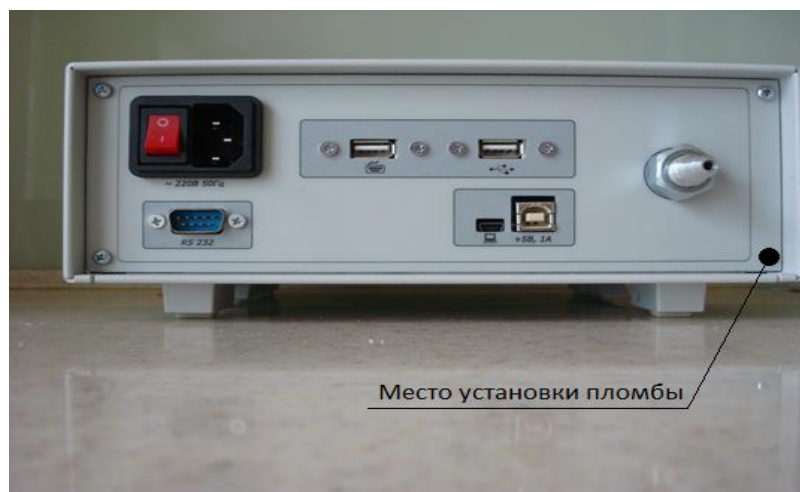
Рисунок 2 – Схема пломбирования барометра БА-1
