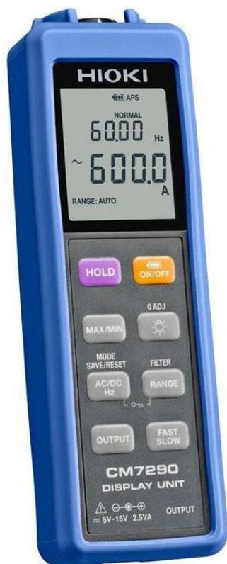
Рисунок 9 - Общий вид внешнего дисплея из состава клещей CM7290
