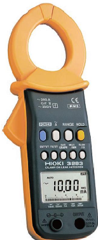
Рисунок 15 - Общий вид клещей 3283
