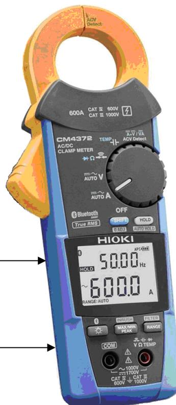
Рисунок 3 - Общий вид клещей CM4371
