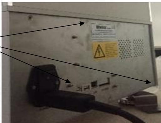
Рисунок 12 - Схема пломбировки тестеров модификаций MultiCheck 6, MultiCheck 6 1000N, MultiCheck 6 Allrounder, MultiCheck 6 Allrounder 1000N от несанкционированного доступа
