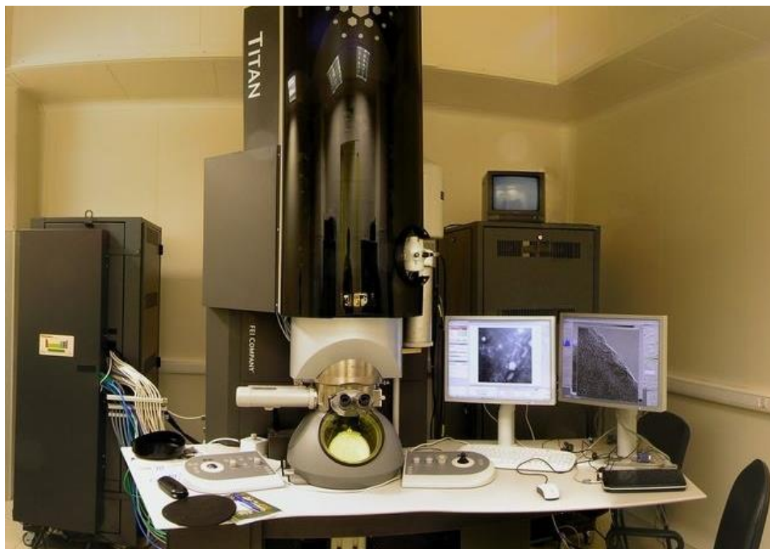
Рисунок 1 - Общий вид микроскопа электронного просвечивающего TITAN 80-300
