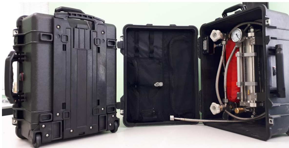
Рисунок 2 - Внешний вид пробоотборного блока комплекса
