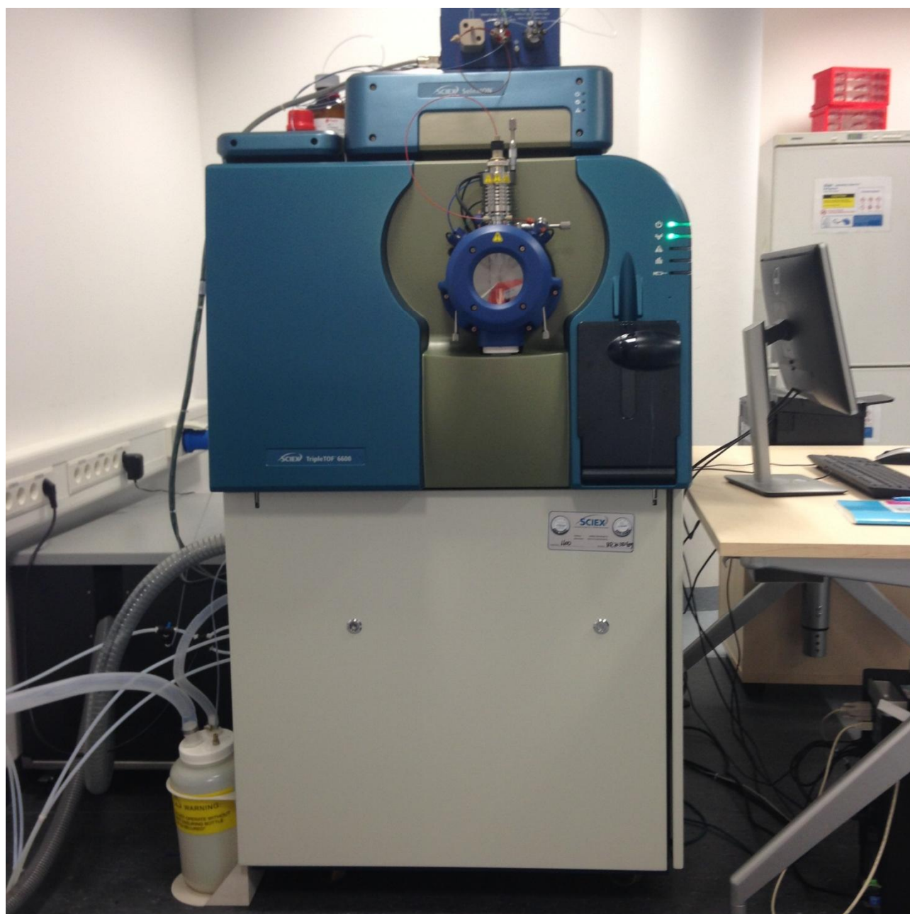
Рисунок 2 - Общий вид масс-спектрометра 6600 TripleTOF с системой дифференциальной ионной подвижности SelexIon сверху
