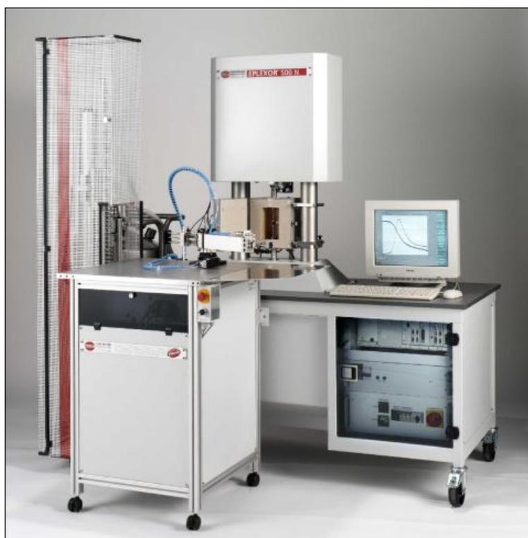
Рисунок 1 - Общий вид анализаторов динамических механических
