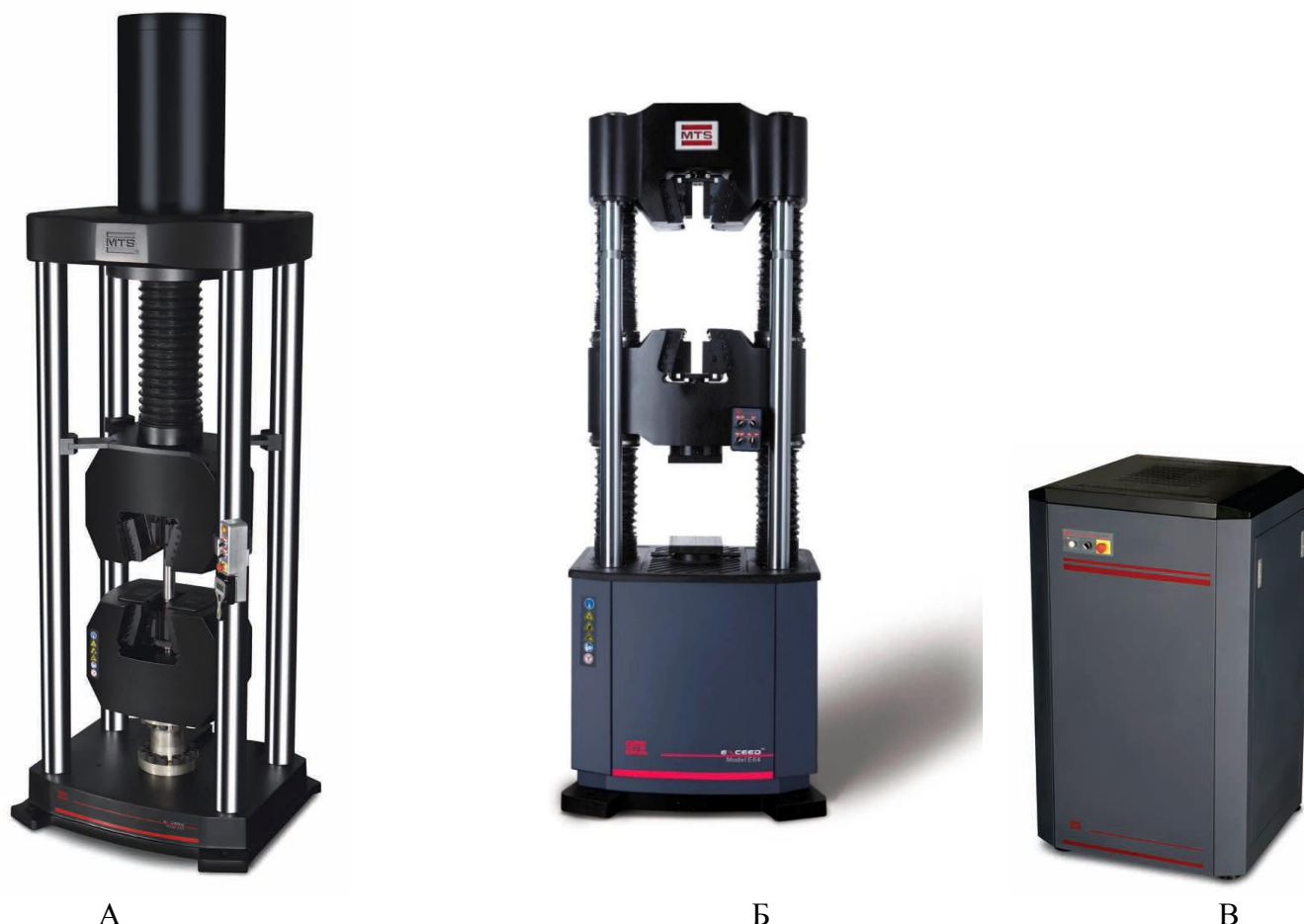
Рисунок 1 - Общий вид машин универсальных испытательных гидравлических MTS Exceed (А- силовая рама модели E65, Б- силовая рама модели E64, В - интегрированная операционная платформа)
