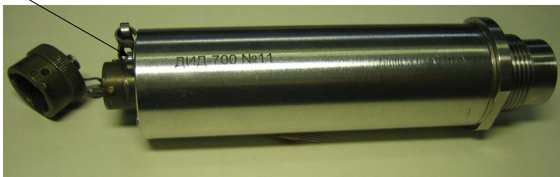
Рисунок 1 - Общий вид датчика с указанием места пломбирования
