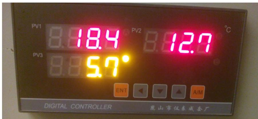
Рисунок 1 - Общий вид измерителя-регулятора температуры цифрового ХМСТ-432А20
