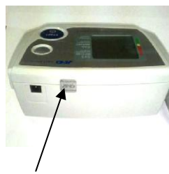
Рисунок 26 - Место нанесения защитной наклейки от несанкционированного доступа
