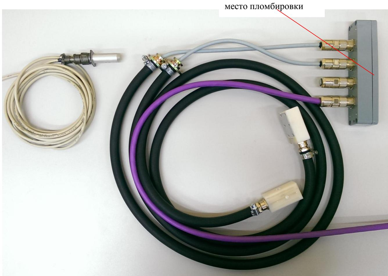
Рисунок 1 – Общий вид измерительных каналов системы СКТР-01, схема пломбировки от несанкционированного доступа
