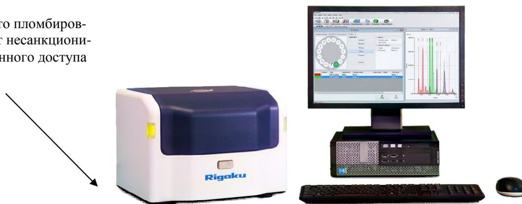
Рисунок 1 – Общий вид спектрометра рентгенофлуоресцентного энергодисперсионного NEX DE, схема пломбировки от несанкционированного доступа
