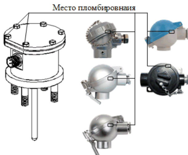
Рисунок 3 – Схема пломбировки от несанкционированного доступа
