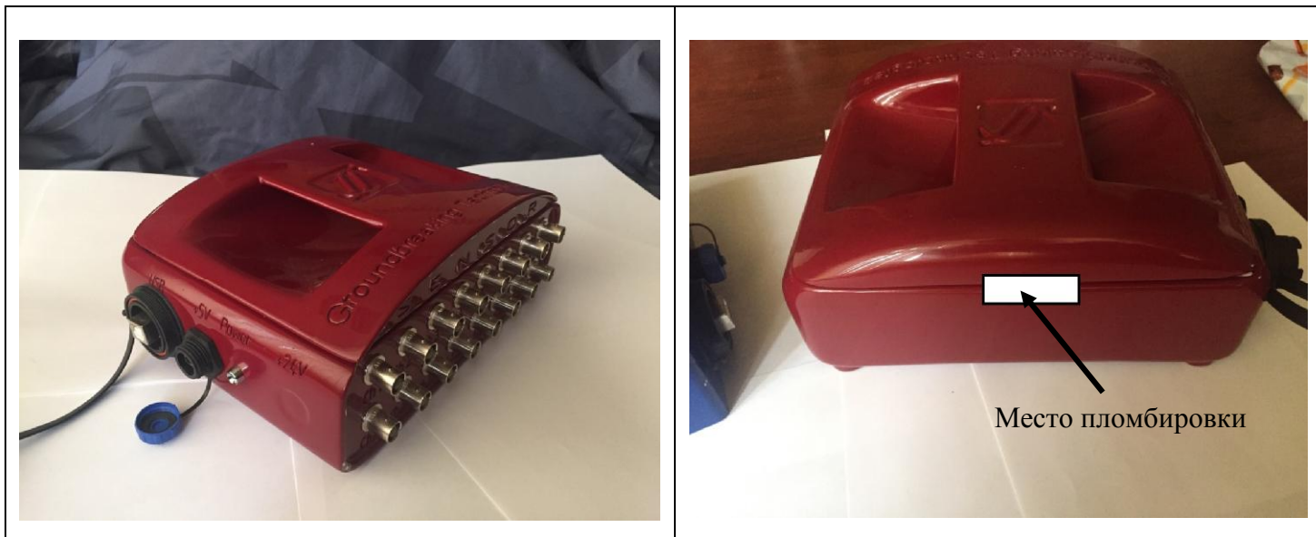
Рисунок 2 - Внешний вид УМС-16-02 (UMS-16-02), схема пломбировки от несанкционированного доступа и место нанесения знака утверждения типа
