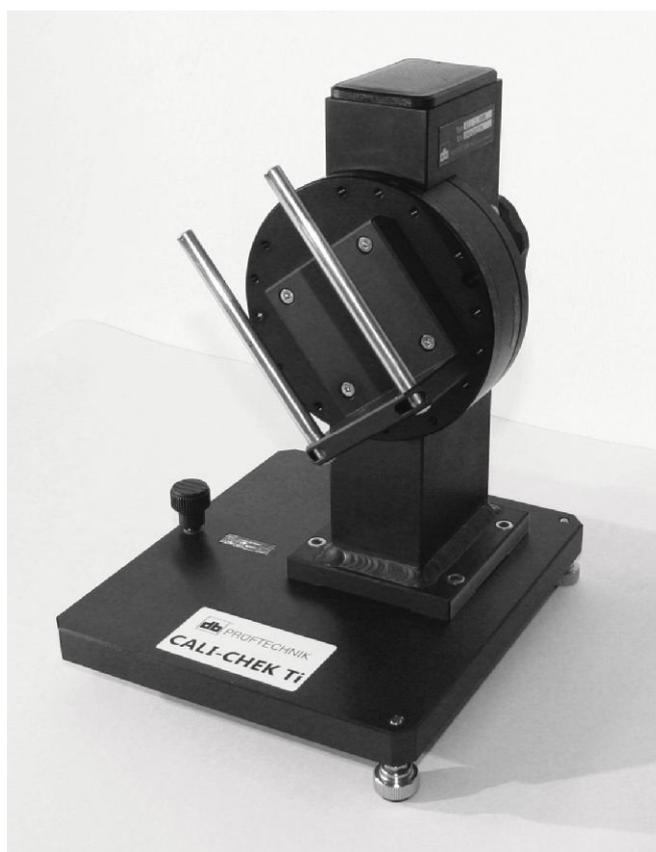
Рисунок 3 – Общий вид установок для поверки систем лазерной центровки PRÜFTECHNIK CALI-CHEK Ti
