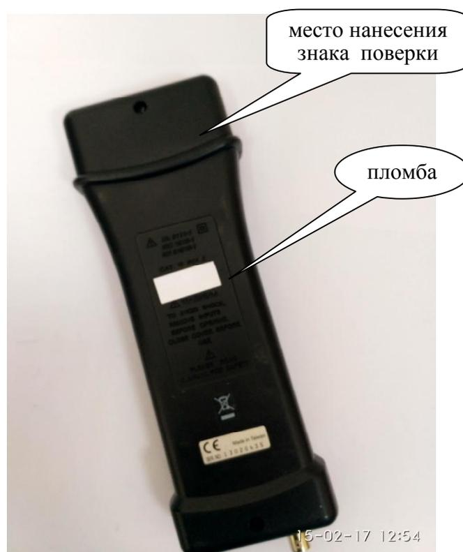
Рисунок 2 – Внешний вид задней панели пробника
