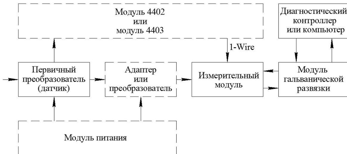
Рисунок 1 - Структурная схема измерительного канала
