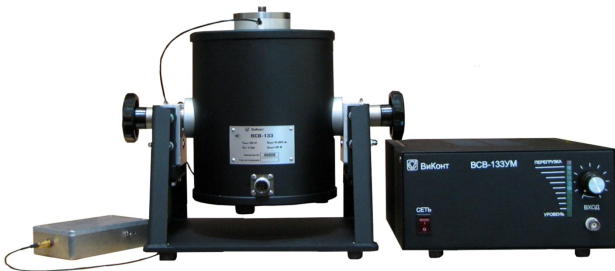
Рисунок 1 – Общий внешний вид виброустановки электродинамической ВСВ-133
