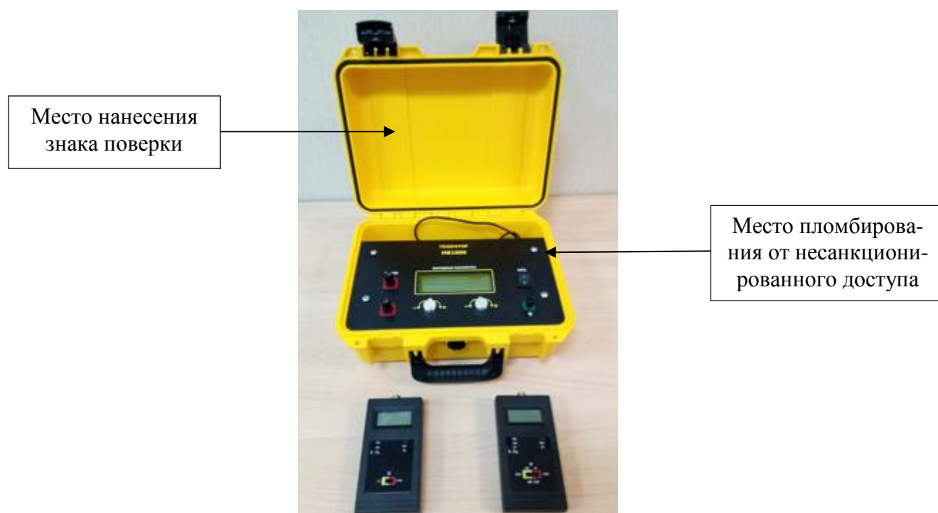
Рисунок 1 - Внешний вид и место пломбирования комплексов
